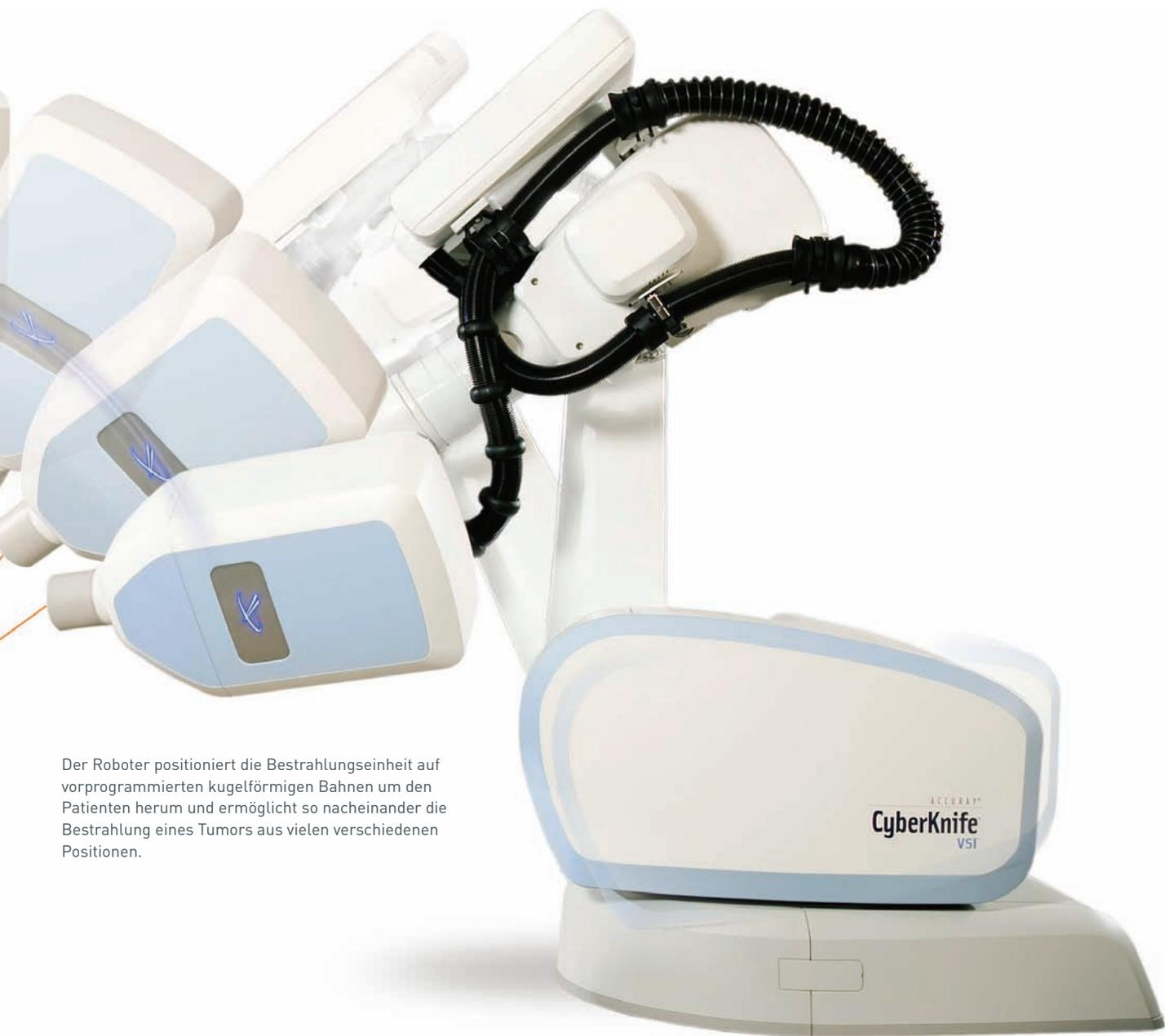
Der Roboter positioniert die Bestrahlungseinheit auf vorprogrammierten kugelförmigen Bahnen um den Patienten herum und ermöglicht so nacheinander die Bestrahlung eines Tumors aus vielen verschiedenen Positionen.
